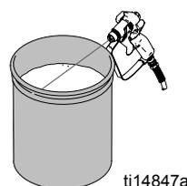
7. Gire la válvula de cebado hacia abajo a la posición de DRENAJE y permita que el fluido de lavado circule hasta que el fluido de lavado aparezca limpio
