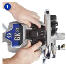
Deslice y levante la tapa de acceso para abrirla
